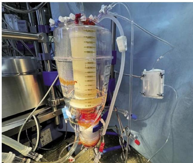
Рис. 3. Пример интеграции плазмофильтра в контур ИК.
